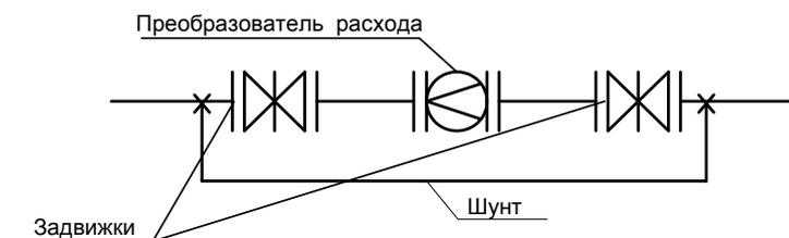
Рисунок 6.1 – Шунтирование преобразователя
